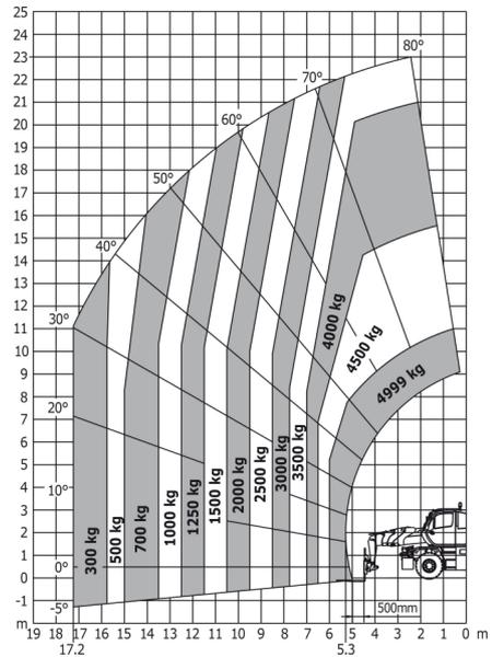
**Drehung an abgesenkten Stützen mit 1000 kg Arbeitskorb**      **Drehung an abgesenkten Stützen mit 1500 kg Ausleger**
