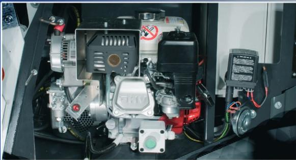
**Optional erhältliches Benzin- oder Dieselaggregat**
