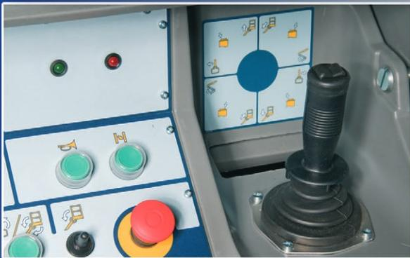
**Stufenlose Steuerung mit einem Joystick**
