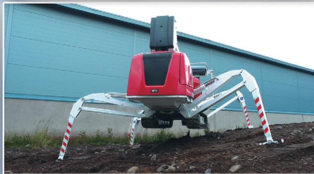
Nivellierbar bis zu einer Geländeneigung von max. 16°.
